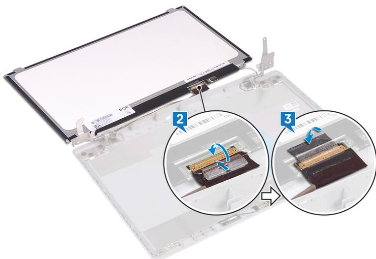
4. Mettez en place le panneau d'affichage sur l'assemblage du cache arrière de l'affichage et de l'antenne.
