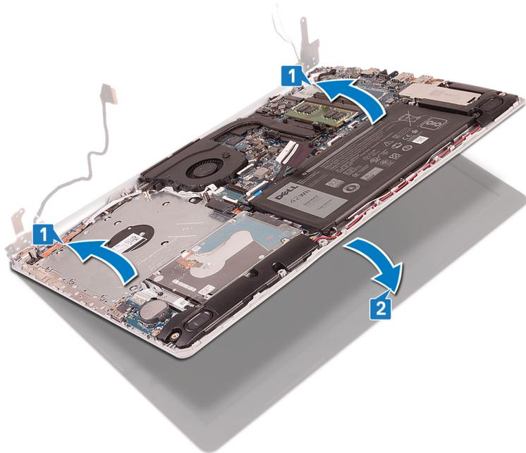
3. À l'aide des détrompeurs, refermez les charnières sur la carte système et l'ensemble de repose-mains et de clavier.
