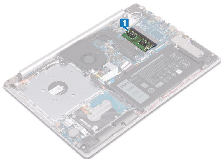
2. Du bout des doigts, écartez délicatement les attaches de fixation situées de chaque côté de l'emplacement de module de mémoire, jusqu'à ce que ce dernier s'éjecte.
