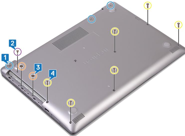
5. À l'aide d'une pointe en plastique, faites levier sur le cache de fond en commençant par le coin supérieur gauche de la base de l'ordinateur.
