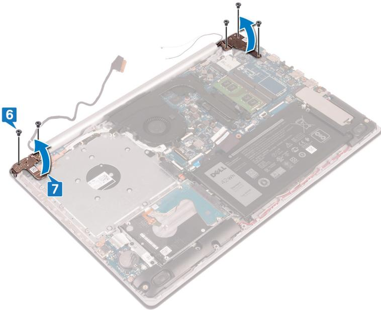
8. Soulevez l'ensemble de repose-mains et de clavier en l'inclinant.
